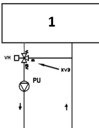
**Circuit hydraulique TCHEY-TCHETU avec configuration HPH/HPHCC avec pompes embarquées**
