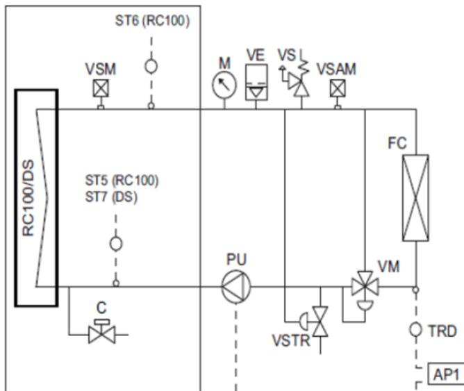
Installation à circuit ouvert (par exemple pour l'eau chaude sanitaire)
