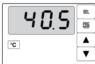
L'insertion dans la machine de l'accessoire thermostat avec écran KTRD permet d'effectuer la configuration du point de consigne d'activation de la commande récupération RC100/DS de l'unité, grâce à la sonde fournie qui doit être placée par l'installateur à l'endroit le plus approprié (p. ex. accumulateur)
