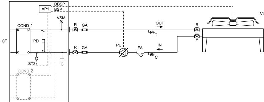
En alternative, il est possible d'utiliser le signal 0-10 V (BSP) déjà présent de série sur les unités pour gérer le contrôle de condensation. Voir la section « Circuits Hydrauliques - Contrôle de condensation avec vanne modulante à 2 voies ou 3 voies ou pompe modulante ».
