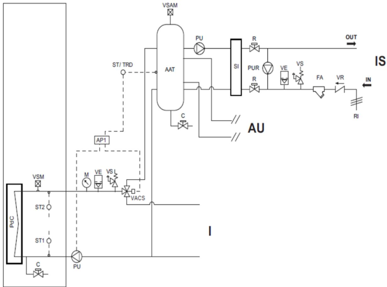
Installation à circuit ouvert et présence simultanée d'une vanne déviatrice à 3 voies VACS et désurchauffeur DS (pour eau chaude sanitaire par exemple)
