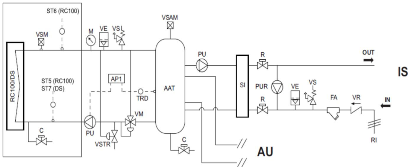
Système en circuit ouvert et présence simultanée de Vanne d'inversion à 3 voies VACS (par exemple pour l'eau chaude sanitaire)
